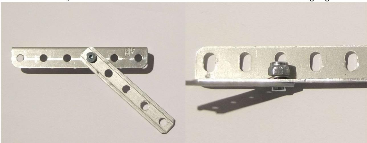
Damit kann die Kraft zwischen den beweglichen Teilen feinfühlig eingestellt werden und bleibt immer gleich. Im rechten Bild sieht man gut die Lage der Wellenscheibe. Im Beispiel mit Verwendung einer Stopp-Mutter.
