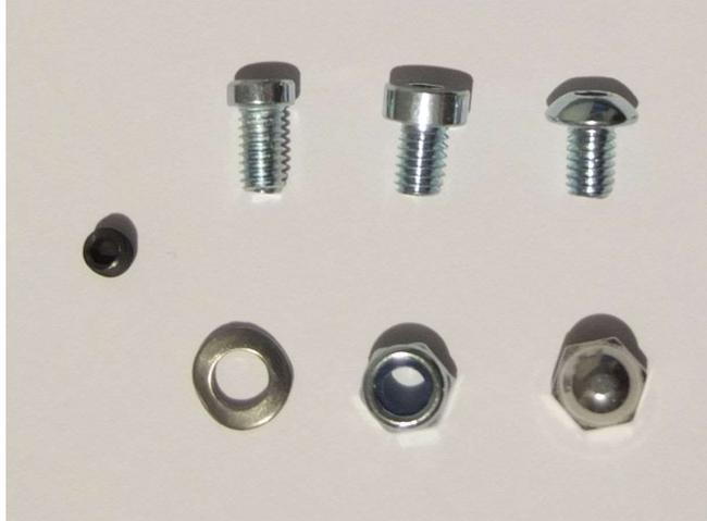
Oben von links: Original Stokys Schraube (keine Norm); Zylinderkopfschraube DIN7984; Linsenkopfschraube ISO7380.
